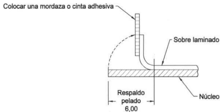
Figura 9. Preparación de la probeta para los ensayos de adherencia
