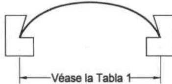
Figura 11. Condición de flexión completa
